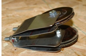
Halterung Querruder Umlenkrollen VA, gem. Zeichnung incl. Umlenkrollen
